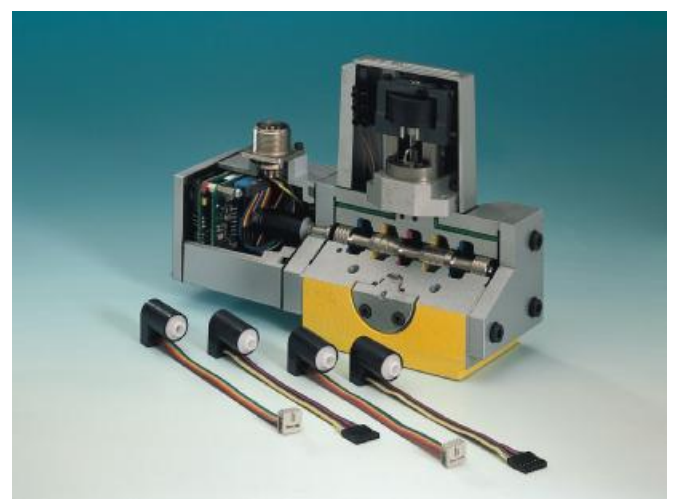
Capteur de déplacement inductifs (Principe - LVDT) in Hydraulikventilen
