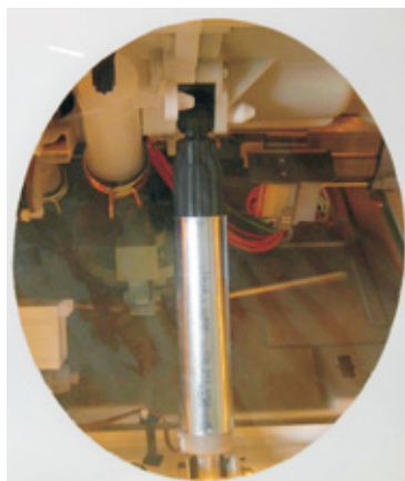
Amortisseur SUSPA avec capteur de déplacement intégré RD 32 FKS
