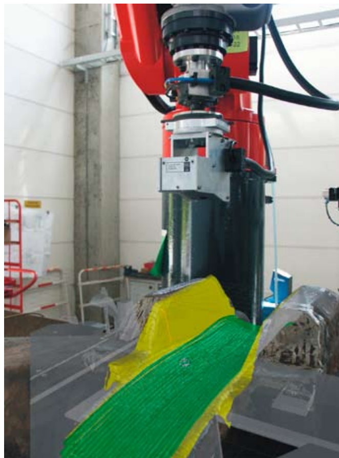
Données scanCONTROL (jaunes), voies de soudure calculées (vertes)
