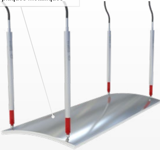
Inspection du fléchissement des plaques métalliques
