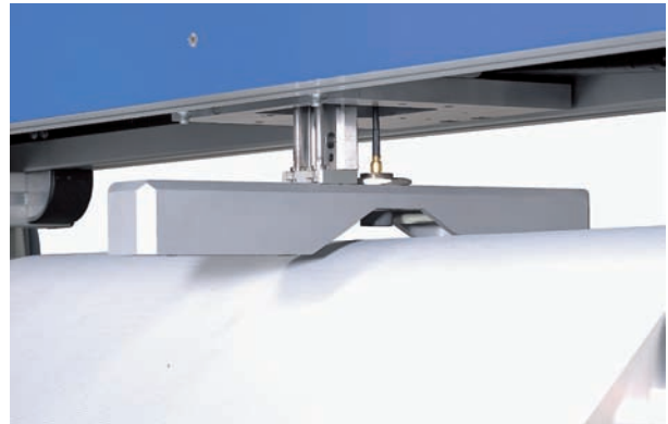
Un système de mesure combiné composé d'un capteur Thru-Beam et d'un capteur à courants de Foucault détecte l'épaisseur des films plastiques défilant sur un cylindre métallique.
