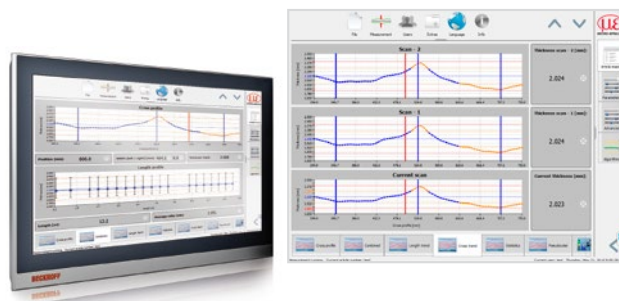
thicknessGAUGE O.IMS Capteurs utilisés : Interféromètres à lumière blanche
