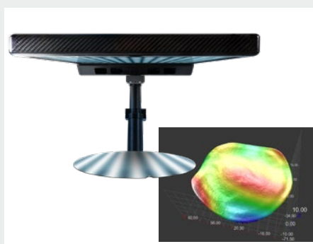
Détection de la forme 3D des wafers
