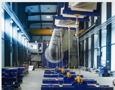
Mesure de la déformation des pales de rotor pour les éoliennes
