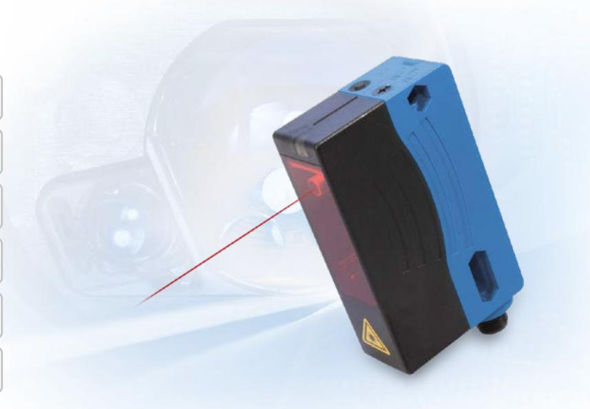
Le fonctionnement des capteurs de déplacement ILR103x/LC1 repose sur le principe du temps de vol. Cette technologie permet de réaliser des résultats précis, fiables, clairs et reproductibles indépendamment des conditions environnantes telles que la nature du matériau, du couleur sombre ou des lumières parasites. Les capteurs utilisent un laser de mesure de la classe laser 1.
