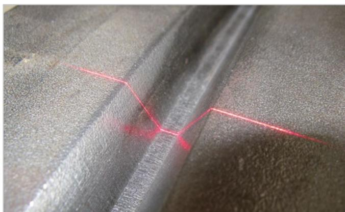
Mesure de la soudure en V sur les tuyaux
