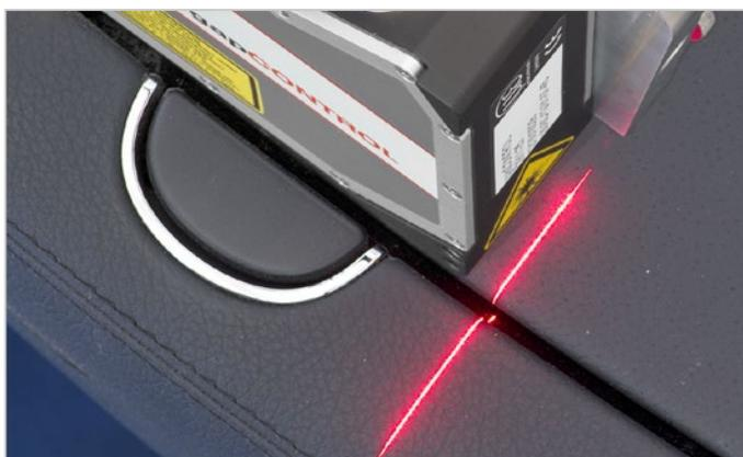
Mesure de distance sur console centrale
