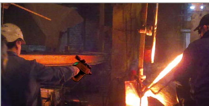
Mesure de température sans contact depuis une distance sûre
