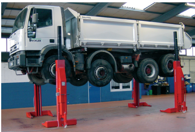
Mesure de la hauteur de levage dans le système de levage synchrone
