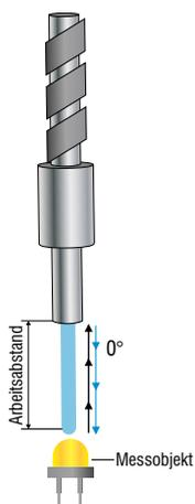
**MFS-I01:** Der MFS-I01 ist dank seines äußerst dünnen Durchmessers von lediglich 1,3 mm für den Einsatz an sehr beengten Bauräumen prädestiniert. Er eignet sich daher perfekt für die Prüfung von SMD-LEDs. Durch die Metallhülse am Sensorkopf ist eine gerade Führung und somit eine exakte Ausrichtung über der LED sichergestellt.
