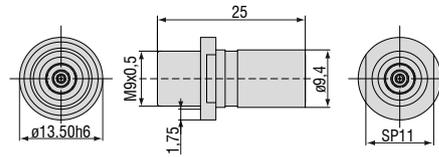
Taux de fuite maximal  $1 \times 10^{-9}$  mbar · l s<sup>-1</sup>, compatible avec les connecteurs de type B
