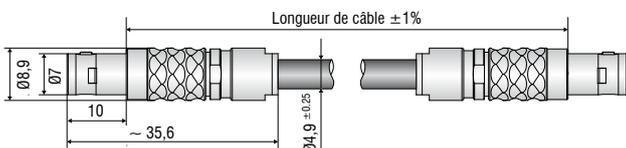
**CA5 Câble de raccordement pour préamplificateur (N° art. 2903180)**
