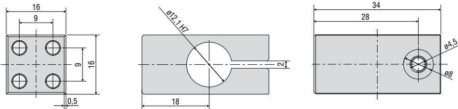
**Accessoires: Capteur-Adaptateur de montage**
