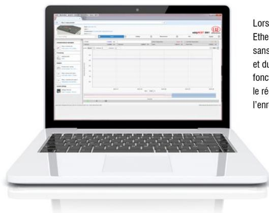
Lors de la connexion d'un PC par le biais de l'interface Ethernet, une interface web moderne peut être chargée sans autre installation et permet le paramétrage du capteur et du contrôleur. La version de contrôleur DT3061 offre des fonctionnalités avancées telles que le calibrage sur 5 points, le réglage des sorties de commutation et de température et l'enregistrement des multiples courbes caractéristiques.
