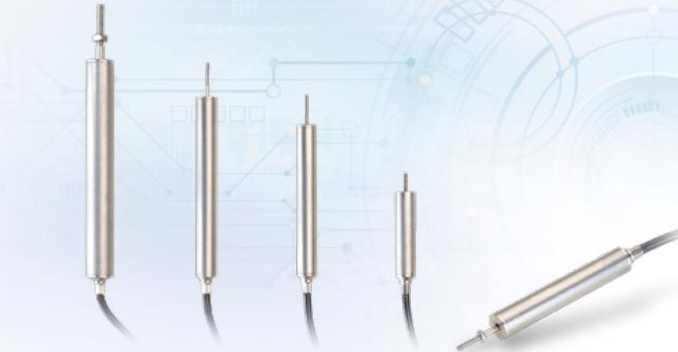
Les capteurs de déplacement LVDT sont équipés d'un coulisseau se déplaçant librement dans le boîtier du capteur. La transmission du mouvement de l'objet à mesurer est assurée par une fixation par filetage du coulisseau à l'objet. Les mesures s'effectuent à l'intérieur du capteur sans contact et ainsi sans usure.
