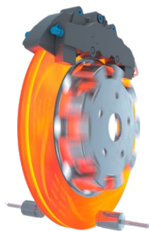
Mesure d'épaisseur des disques de frein
