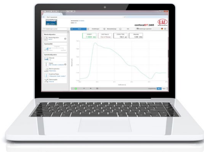
L'interface web permet de procéder à tous les paramétrages. Une base de données de matériaux extensible à volonté existe pour la mesure d'épaisseur.
