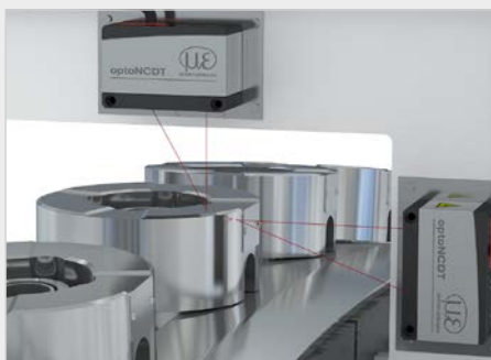
Mesure des porte-outils en magasin
