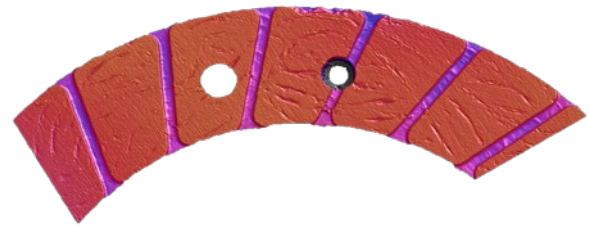
Détection et évaluation des ruptures sur les disques d'embrayage
