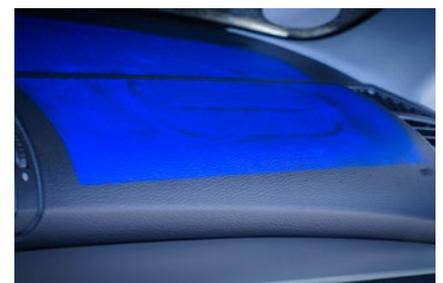
Rétroprojection pleine surface du résultat de l'inspection
