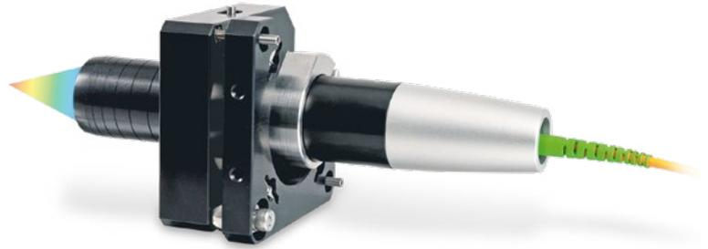
Le montage orthogonal est une condition préalable, notamment pour les capteurs haute résolution à faible angle d'inclinaison. L'adaptateur de montage JMA-xx permet, grâce à son mécanisme de réglage simple, d'orienter finement le capteur sur l'objet à mesurer. Cela permet de compenser facilement les légères différences de montage ou les inclinaisons de l'objet à mesurer.
