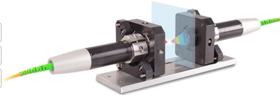
L'adaptateur de montage JMA-Thickness permet d'aligner les points de mesure les uns par rapport aux autres lors de la mesure d'épaisseur bilatérale. Ainsi, les points de mesure sont disposés de manière absolument coïncidente, de sorte que les capteurs se trouvent exactement sur un axe optique. Cela permet d'éviter une mesure décalée et d'obtenir un résultat de mesure fiable avec une précision maximale.
