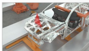
Contrôle de l'assemblage en caisse en blanc
