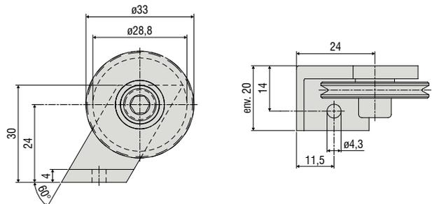
**Poules de renvoi pour l'installation directe sur le boîtier du capteur**
