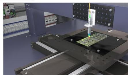
Mesurer des composants électroniques dans les machines de mesure des coordonnées
